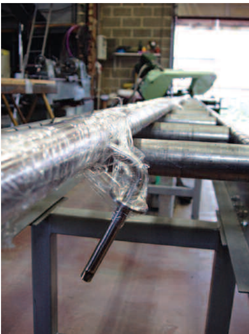
Fertiggestellte Konstruktionen müssen bei Lagerung, Transport und Handhabung vor mechanischer Beschädigung und Fremdeisenkontamination geschützt werden.
