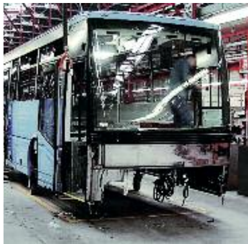
Figura 25: Empleado en autobuses, el acero inoxidable (generalmente un tipo ferrítico pintado) ha demostrado ser compatible con un chasis de acero al carbono.
