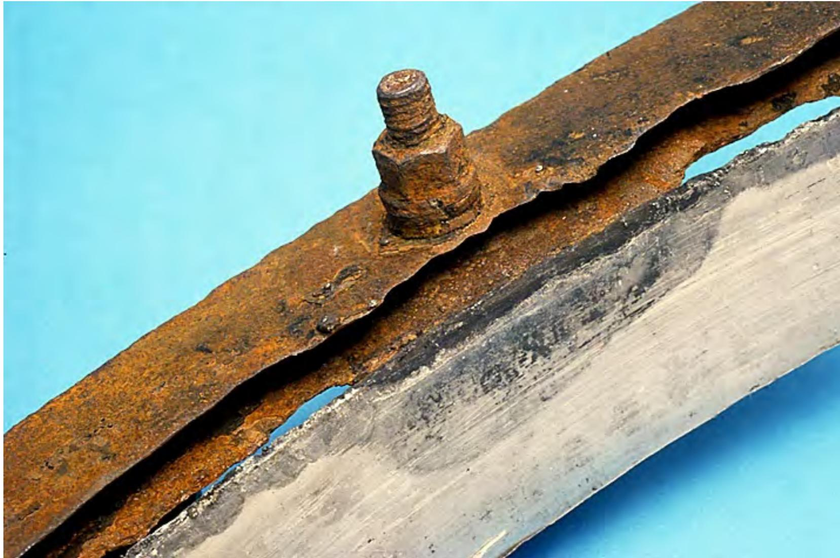
La corrosión galvánica entre un anillo de soporte de acero al carbono y un gran tanque de almacenamiento de agua caliente tipo 304 al que va soldado. El tanque estaba revestido con fibra de vidrio y el agua se filtró en el revestimiento.
