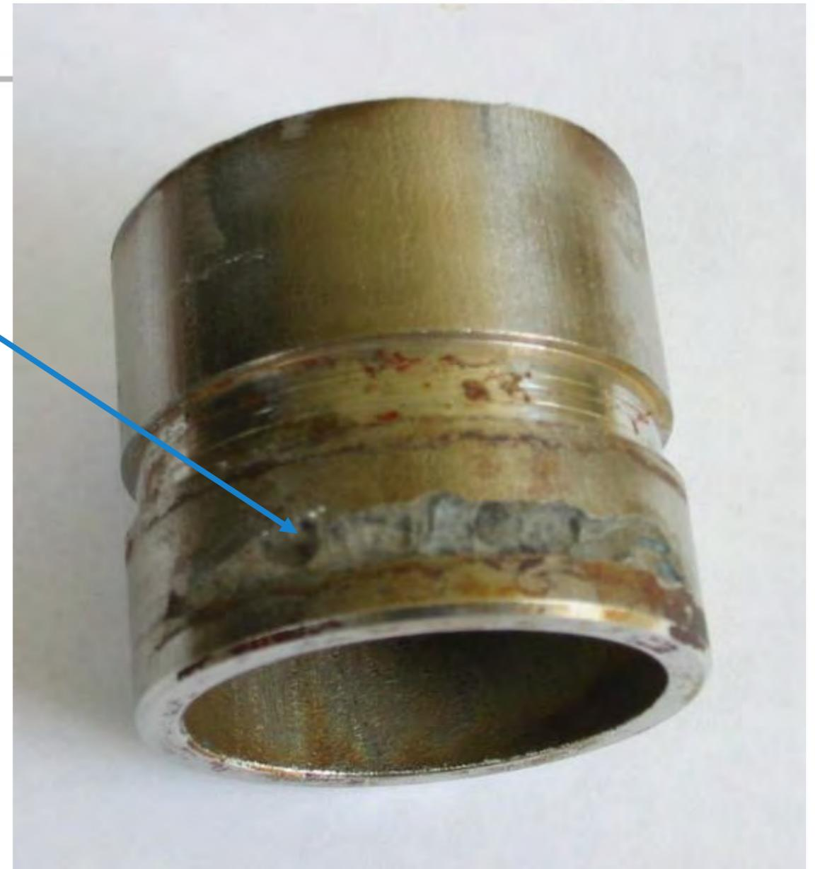
Tipo 316 utilizado en un acoplamiento Victaulic para la desalinización por ósmosis inversa en agua de mar. Fue reemplazado con éxito por un acero inoxidable al 6% Mo.
