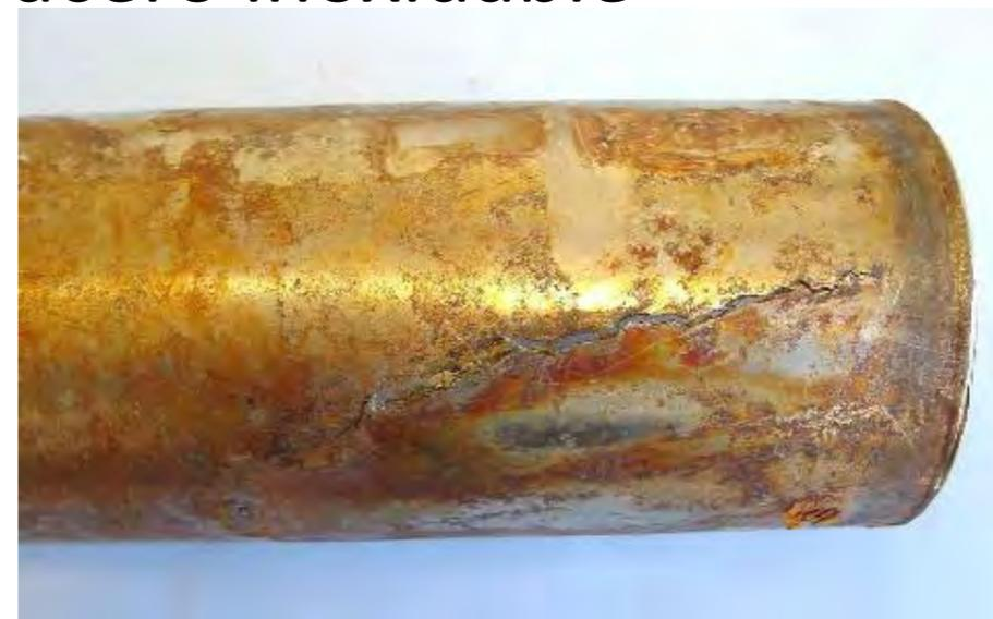
SCC por cloruros formada en el exterior de una tubería T-304 de 2 años que transporta agua a 90°C en una bodega.
