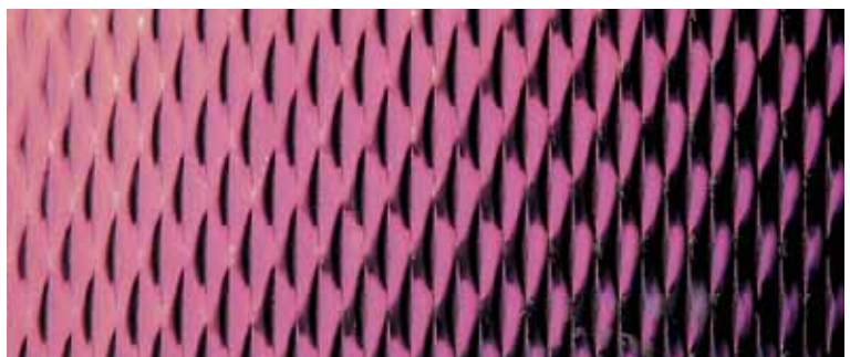
Alkuperäinen pinta ja sen kiiltoaste eivät muutu sähkökemiallisessa värjäyksessä.
