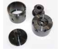
Sputteroimalla voidaan aikaansaada erityisen kulutuskestäviä pinnoitteita. Kuva: Inox-Color, Walldürn (Saksa)
