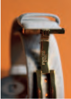
PVD-Beschichtungen ergeben Oberflächen von hoher Kratzfestigkeit.
