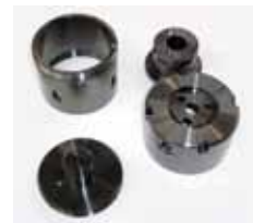
Naprašováním je možno vytvářet keramické povrchy mimořádně odolné proti opotřebení. Fotografie: Inox-Color, Walldürn (D)
