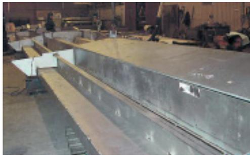
La viga soporte del puente fue íntegramente prefabricada en tres secciones en un astillero.
