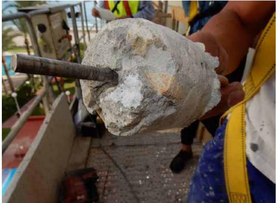
Muestra para probeta
