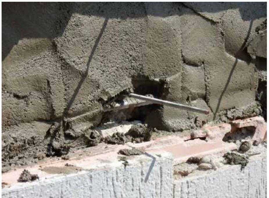
Foto 35.Detalle de conexión eléctrica para posteriores mediciones
