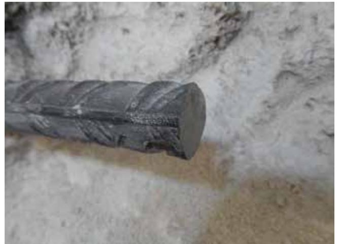
Foto 41. Detalle del extremo tras el cepillado
