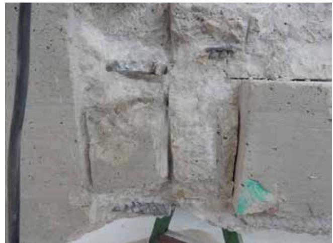
Foto 105. Resultado corte armaduras
