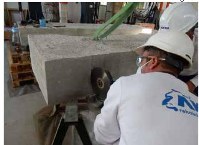
Foto 81. Corte del hormigón
