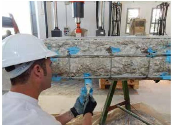
Foto 73. Aplicación protección anticorrosión
