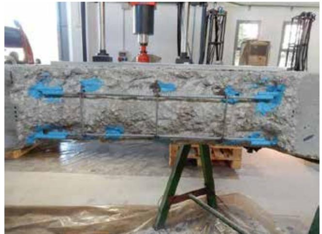
Foto 74. Resultado aplicación protección anticorrosión
