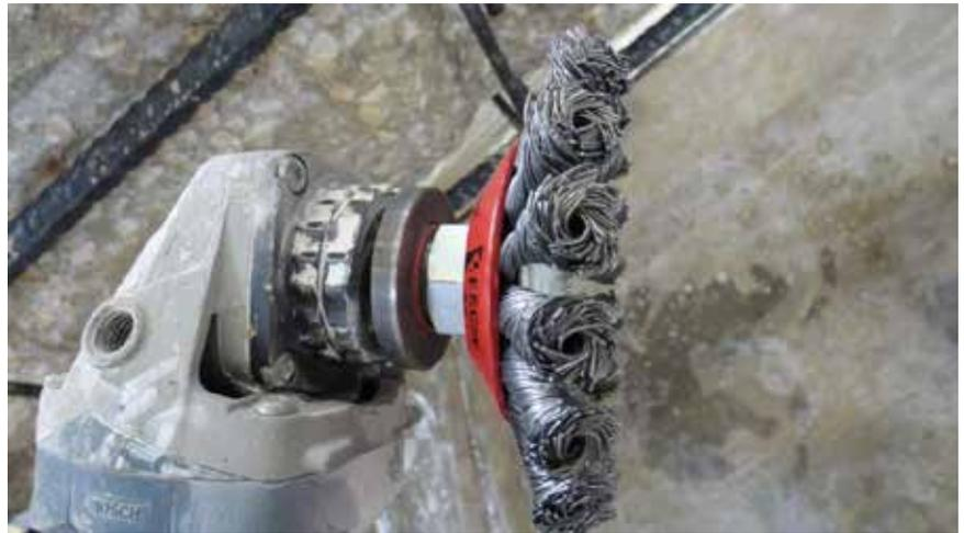
Foto 10. Disco de alambres de acero para limpieza de barras
