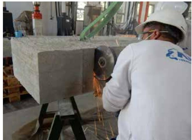
Foto 84. Corte del hormigón
