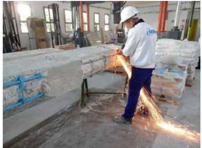
Foto 31. Proceso de corte de los estribos
