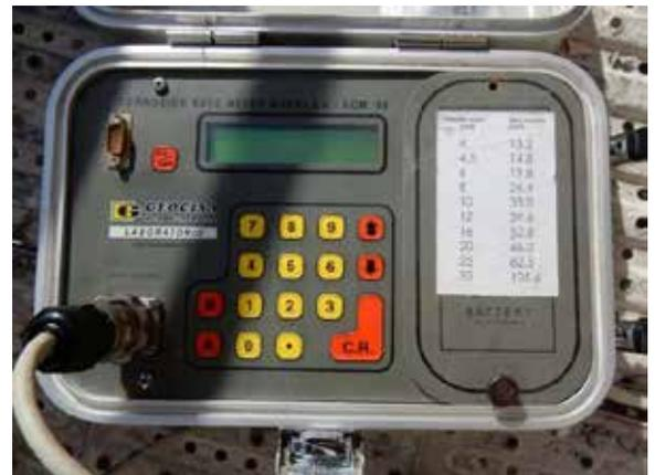
Medidor de corrosión
