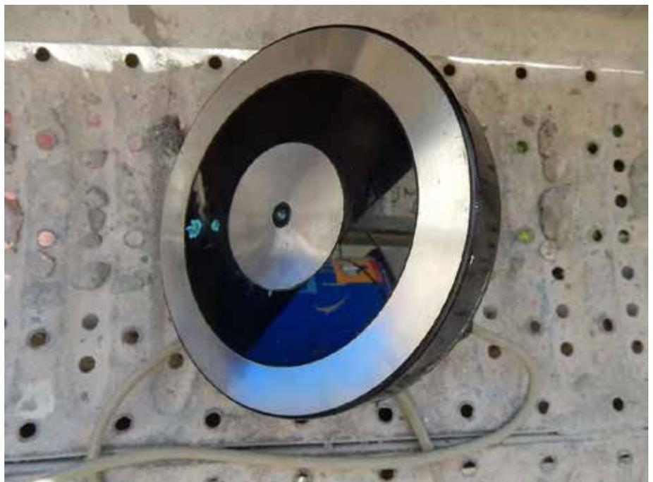
Sensor para medición de corrosión
