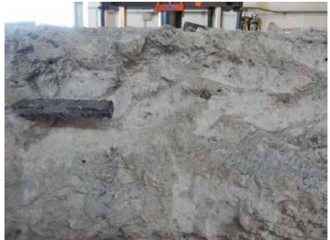
Foto 35. Detalle del estado tras el corte: armadura y estribo
