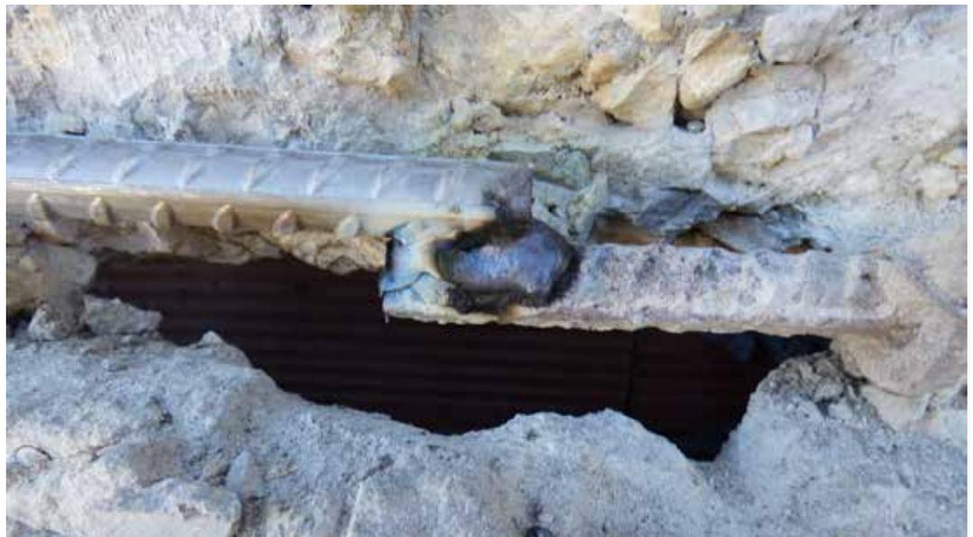
Foto 26. Detalle de prueba de soldadura en obra
