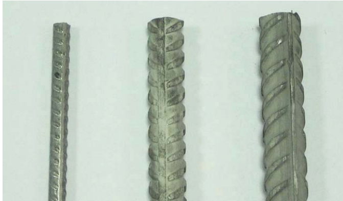
Figura 7 Barra Ø8 laminada en frío (izq), y barras Ø16 y Ø20 laminadas en caliente.
