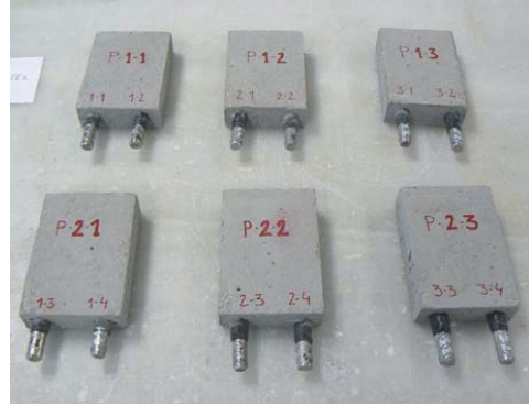
Figura 3 Probetas de mortero transcurridos 28 días de curado.
