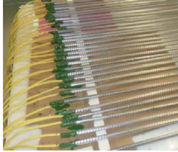
Figura 5 Barras de acero inoxidable con las conexiones eléctricas.
