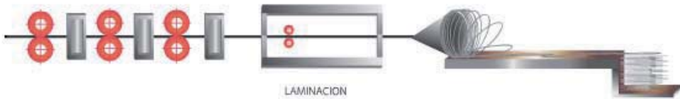
Figura 6 Esquema del proceso de laminación en caliente.
