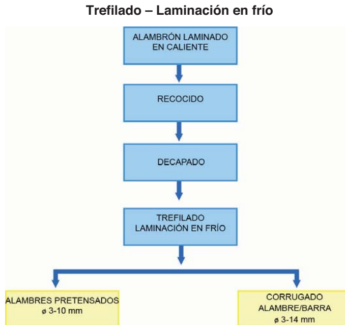
Figura 12 Esquema del proceso de trefilado o laminación en frío.
