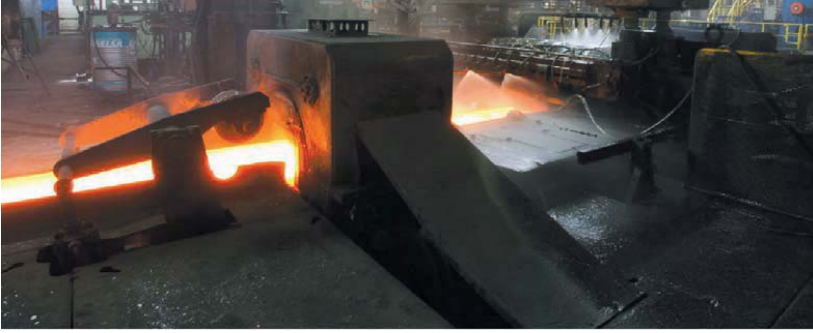
Figura 8 Tren de laminación de palanquilla. Fuente: Roldan.
