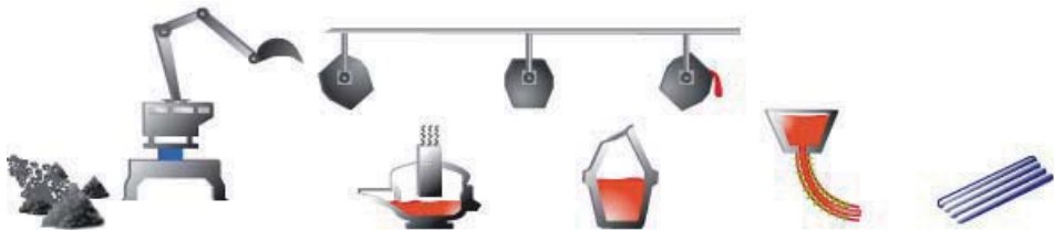
Figura 3 Esquema de fabricación de la acería.
