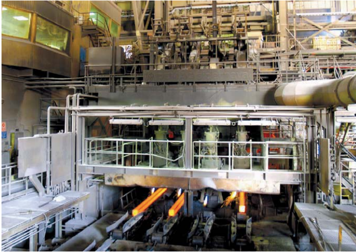
Figura 5 Palanquillas saliendo de la colada continua. Fuente: Acerinox.
