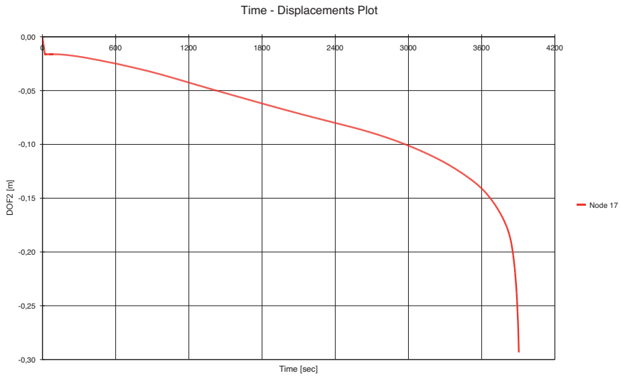
Figura 23 Evolución del desplazamiento frente a una carga de 20 kN/m en acero al carbono.
