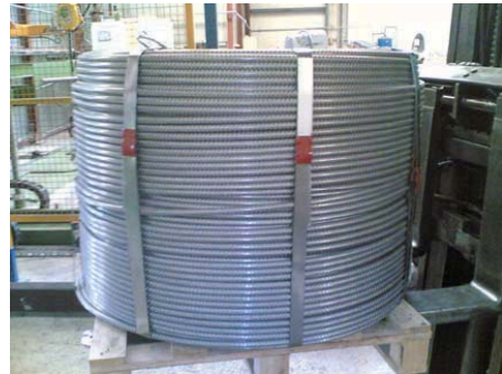
Figura 13 Alambón corrugado de Inoxfil en rollos trancanés.
