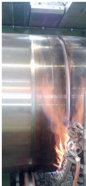
Figura 3. Soldadura del cuerpo del contenedor ENUN
