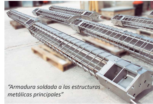
"Vigas armadas para los pilares estructurales"
