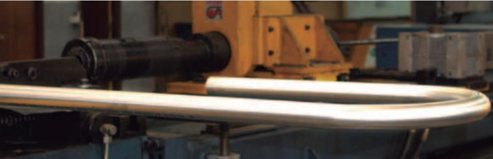
**E**n procesos de deformación plástica, factores como la resistencia, módulo de elasticidad y ductilidad son muy importantes. El doblado de tubo es un trabajo complejo, ya que la pieza tiende a romperse o deformarse. Los tubos son más débiles cuanto mayor
