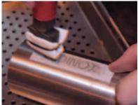
También sirve para realizar marcajes con una plantilla o etiqueta impresa, se puede marcar en oscuro, con una capa de oxidación de la zona deseada. Ambos métodos son perdurables y resistentes contra los agentes químicos y la abrasión, y se usan a menudo para marcar herramientas o utensilios sanitarios.
