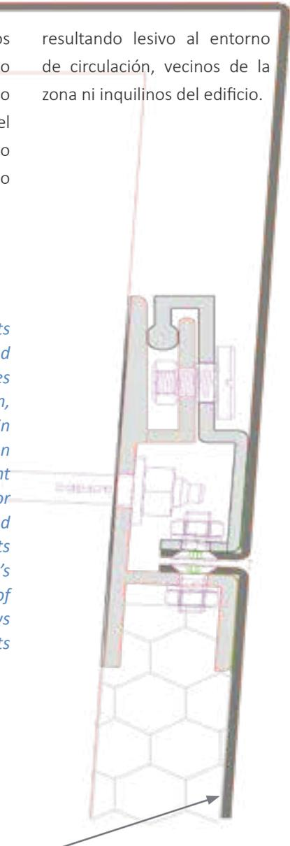
Chapa de acero inoxidable Linen AISI 304L espesor 1,5 mm
